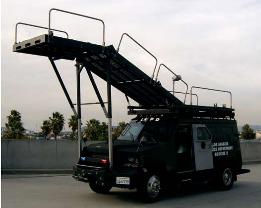
Należący do Departamentu Policji z Los Angeles, pojazd Lenco Beracat wyposażony w rampę Liberator .
